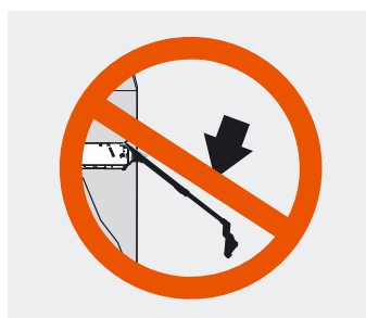
Não pressionar a alavanca telescópica para baixo, mas sim, desmontá-la
