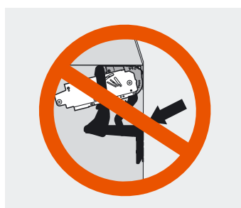
Não pressionar o pacote da alavanca para baixo, mas sim, desmontá-lo
